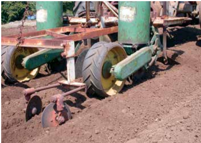
FIGURA 4. Discos aporcadores. Arriman una capa de tierra sobre la línea de semillas. Foto: Jim Leap
