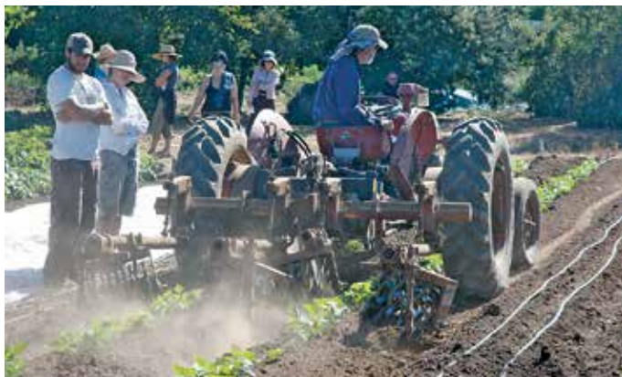
FIGURA 6. Una cultivadora rotativa vuelve a formar las camas de siembra, aporrea tierra a las plantas de frijol, y tapa las cintas de goteo y las malezas.
